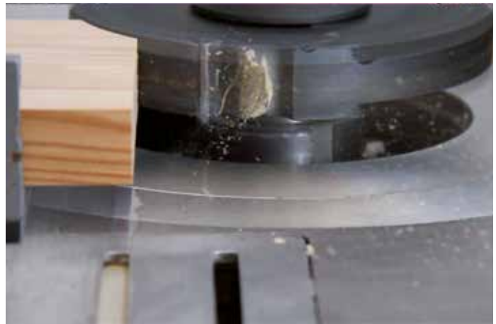
Sistema de flujo de virutas - óptima descarga de las virutas. Sistema de fluxo de aparas - Descarga de aparas otimizado.
