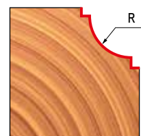
Con cojinete Ø 12,7 mm Com rolamento de ø 12,7 mm
